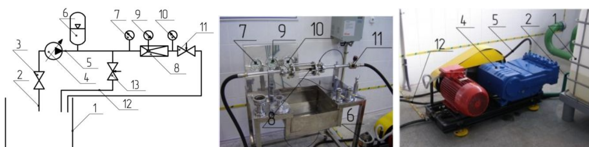
Рис. 1. Внешний вид и принципиальная схема экспериментальной установки для исследования моделей пеногенераторов
